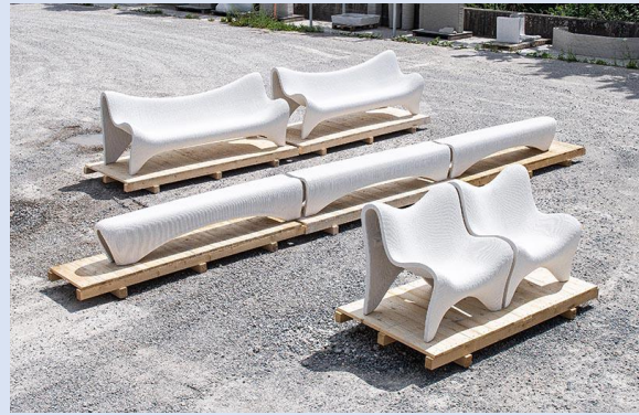
(شکل ۵-۶) نمونه‌های ساخته شده از صندلی و میلمان با چاپ سه بعدی
